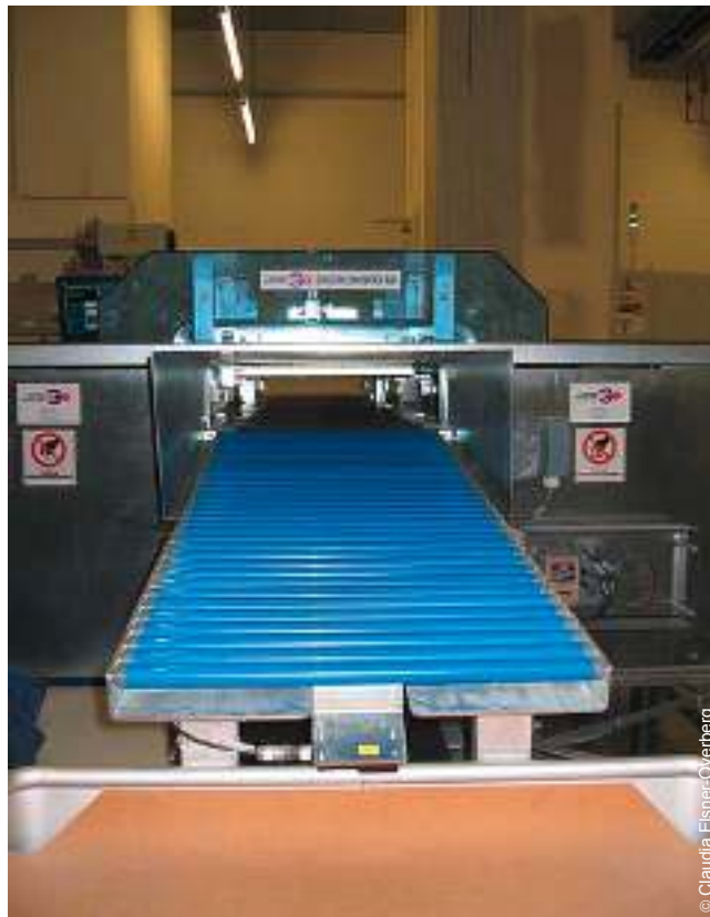
Buchtransportanlage von GilgenLogistik
